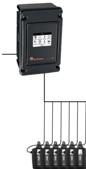
Bild 2: An einen Datenlogger können bis zu 6 NH 3 -Sensoren des DOL 53 angeschlossen werden Figure 2: Up to six ammonia sensors can be plugged in a DOL 53 data logger
