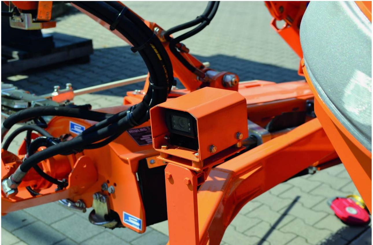
**Bild 1:** Beispiel einer Kamerainstallation eines Vorbau-Kamera-Monitor-Systems (VKMS) an einem Frontgerät (Foto DLG, Frankfurt a.M.)
