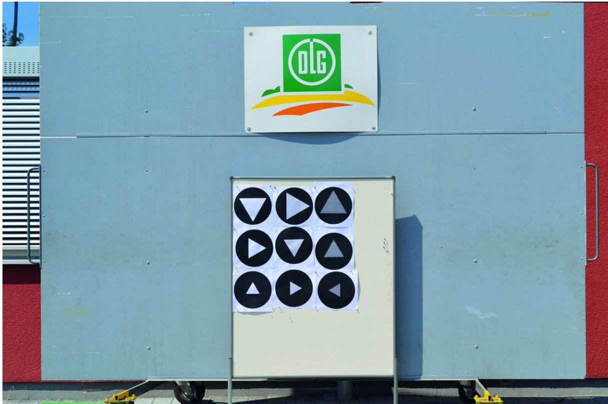
**Bild 2:** Der Triangle-Discrimination-Test der DLG für Vorbau-Kamera-Monitor-Systeme (VKMS) (Foto DLG, Frankfurt a.M.)
